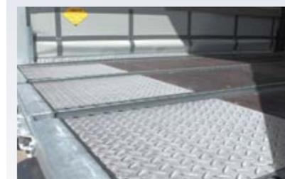
La lamiera scanalata sul lato posteriore, a filo con pianale e rotaie Joloda protegge il pianale nel funzionamento con rampa.
