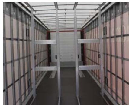
Quattro guide parallele forate continue provvedono al fissaggio rapido di carichi parziali ad accoppiamento geometrico con barre di bloccaggio.
