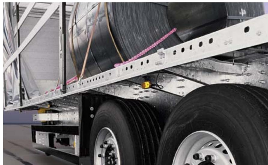
La struttura dello chassis è in grado di sostenere un baricentro di 30 t a 1,5 m e, con un'autorizzazione speciale, consente di effettuare trasporti con un peso complessivo di 45 t per carichi indivisibili in una combinazione a 5 assi con la motrice.
