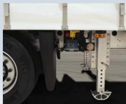
Un supporto per pendenza in alluminio (opzionale) nella parte posteriore offre al veicolo un piano sicuro in fase di carico.
