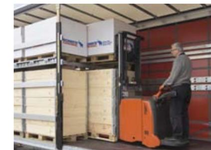
Efficienti sistemi di avanzamento a pavimento caricano contemporaneamente due livelli dalla rampa di carico o dal pavimento.
