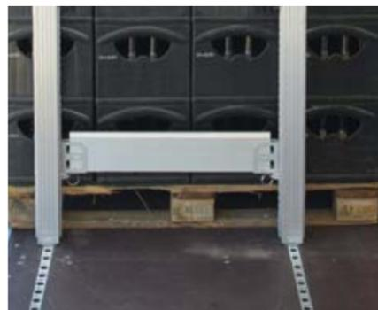
Per il fissaggio del carico nell'industria delle bevande possono essere utilizzati sopralzi corti tra le barre di fissaggio del carico.
