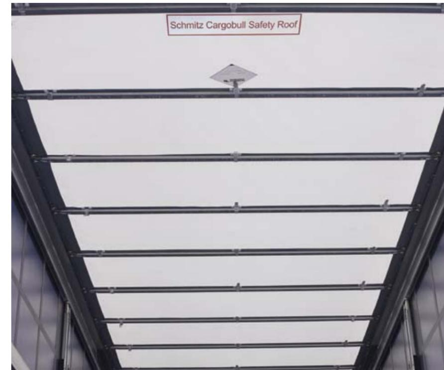
Lo Schmitz Cargobull Safety Roof è parte integrante del sistema di carrozzeria FLEXOS e non richiede rinforzi supplementari per il fissaggio del carico.
