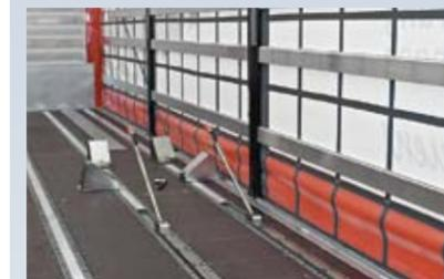
Le guide continue in acciaio Joloda in combinazione con rulli Joloda consentono la movimentazione manuale di bobine di carta e pallet all'interno della superficie di carico.
