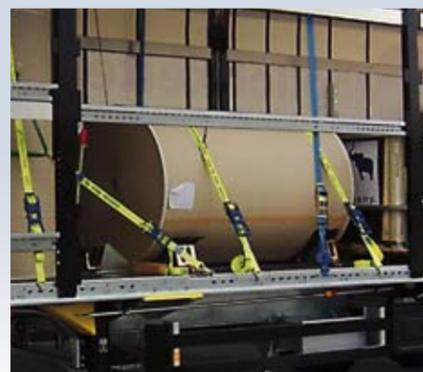
Fissaggio del carico certificato con il sistema. Nella direzione longitudinale o trasversale, fissato con ancoraggi o per mezzo di cunei di sicurezza regolabili nonché in posizione verticale, fissato con lashing di testa o tappetini antiscivolo supplementari.
