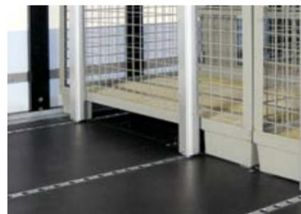
Fissaggio di carichi parziali con barre di bloccaggio per merce su pallet o gabbie a griglia metallica nel S.CS MEGA con SPEED CURTAIN.
