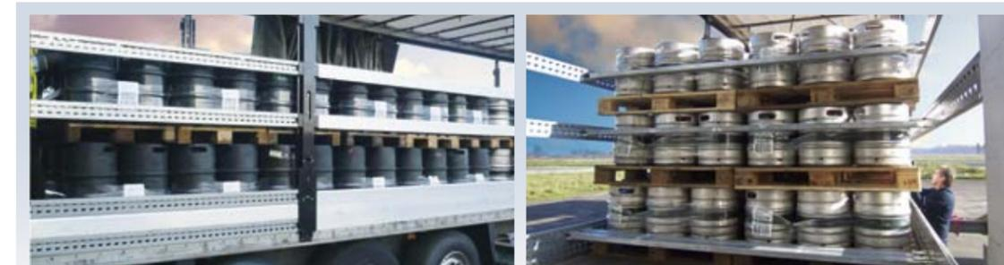
Le caratteristiche certificate della struttura consentono un trasporto senza ancoraggi inferiori per fusti in acciaio imballati su pallet o fusti non imballati con rivestimento in plastica. Sono obbligatori quattro sopralzi in alluminio. Qui in combinazione con sopralzi in acciaio con perforazione per la ricezione delle barre trasversali.
