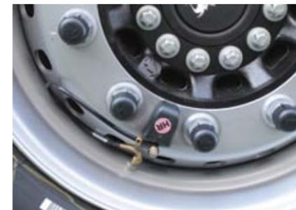
Sensori sulla ruota trasmettono la pressione alla motrice, al sistema informativo trailer TIS e alla telematica trailer.
