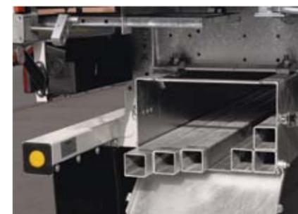
Per montanti a innesto non necessari, sull'autotelaio si trova un deposito per 8 montanti\*.
