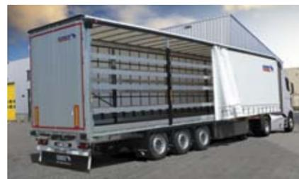
Il lato forte: dispositivo di arresto pallet, sopralzo in alluminio e montanti rinforzati.
