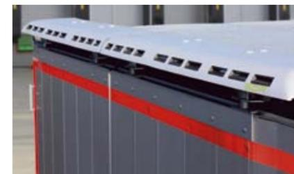
Uno spoiler opzionale sulla parte posteriore del trailer riduce l'afflusso d'aria dietro la motrice e consente un risparmio fino al 3% di carburante.
