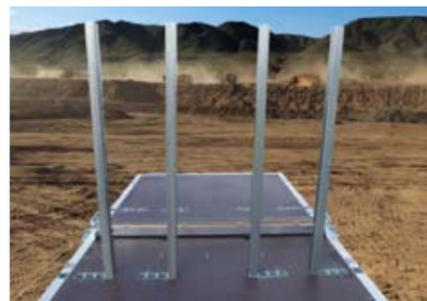
Fissaggio del carico flessibile di materiali lunghi: otto file con tasche per montanti trasversali sono incassate a livello nella superficie di carico per la ricezione di supporti per montanti verticali.
