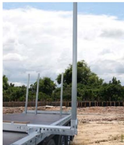
Per il trasporto di reti metalliche per l'edilizia di larghezza eccezionale possono essere montati complessivamente quattro supporti trasversali sulla superficie di carico con tasche per montanti estraibili (fino a 3.200 mm) (opzionale).
