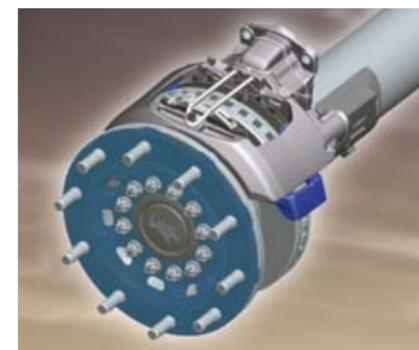
L'autotelaio ROTOS con pastiglie dei freni 19,5", elevata potenza nonostante il diametro ridotto e il peso contenuto.
