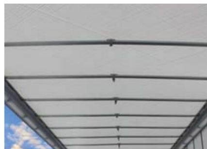
Il nuovo Safety Roof Schmitz Cargobull con rinforzo diagonale integrato mediante fibre di plastica ad alta resistenza aumenta la robustezza strutturale in modo permanente, cosicché nella carrozzeria SPEED CURTAIN e nel carico su due livelli è possibile evitare i rinforzi del tetto finora abitualmente in uso. La maneggevolezza nell'apertura diventa più facile, l'altezza utile interna più grande.
