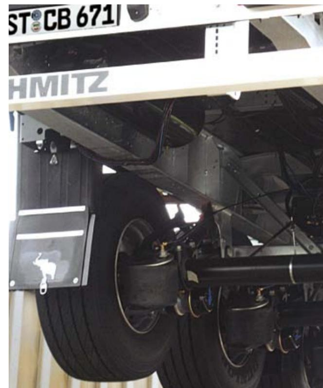
Le molle ad aria con Splitter speciale per il trasbordo verticale evitano danneggiamenti del soffietto.
