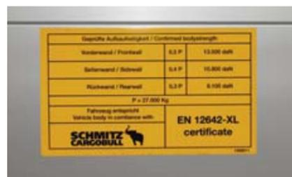
I valori di resistenza della struttura sono applicati in modo visibile sulla sponda anteriore.
