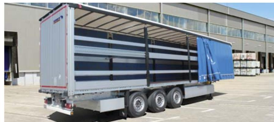
La robustezza strutturale certificata a norma DIN EN 12642 Codice XL soddisfa i requisiti della direttiva VDI per il trasporto di bevande e quelli della Daimler RL 9.5 per il trasporto di merci su supporti del carico.
