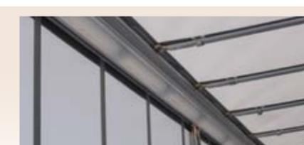
La centina tetto alta 180 mm della copertura MEGA consente il carico a larghezza pallet fin sotto il tetto.
