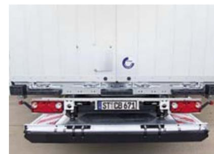
Scarico veloce anche senza rampa e carrello elevatore con la sponda di carico ribaltabile\*.
