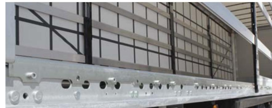
Un foro passante di ancoraggio sul telaio esterno e i dispositivi di arresto pallet ad esso avvitati garantiscono un ancoraggio inferiore più semplice del carico in quasi tutti i punti e bloccano il carico per evitare che si sposti lateralmente.
