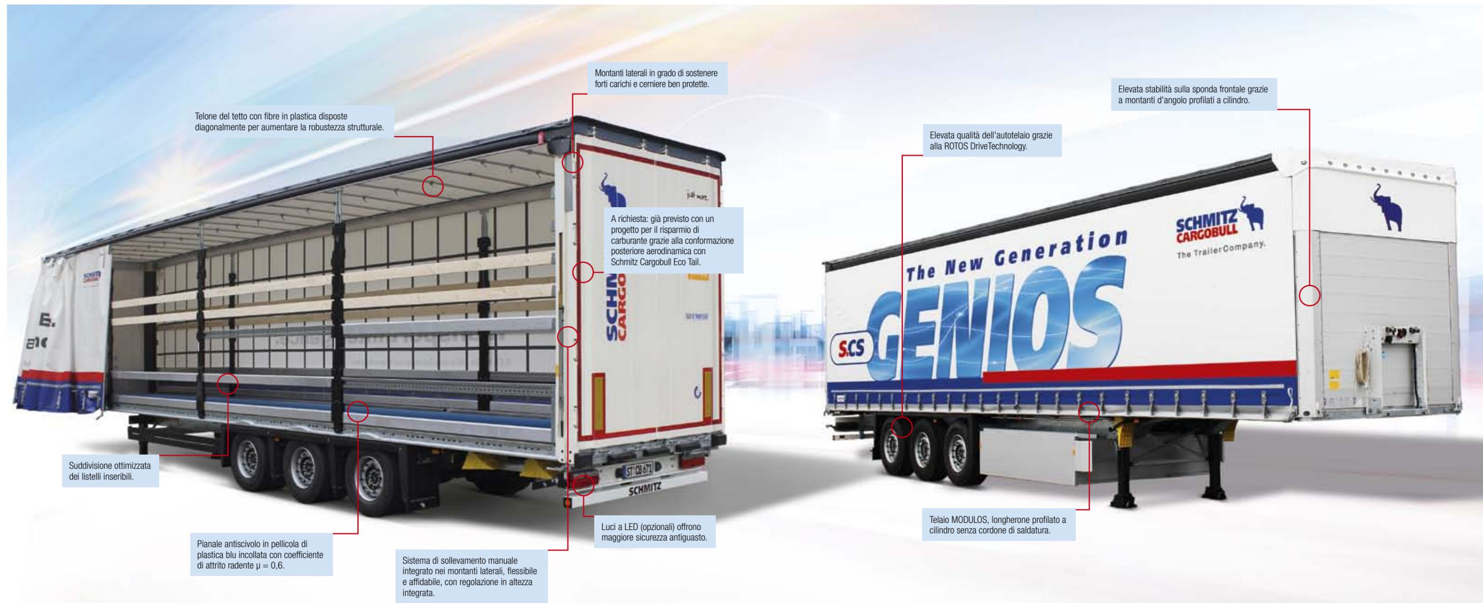
Telone del tetto con fibre in plastica disposte diagonalmente per aumentare la robustezza strutturale.
