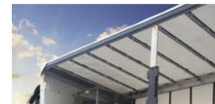
Con il sistema di sollevamento manuale nel montante laterale è possibile sollevare il tetto a sinistra, a destra o su entrambi i lati.
