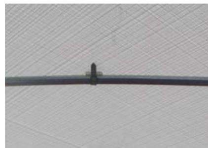
Opzionale per trasporti di bevande: Schmitz Cargobull Safety Roof con fibre in plastica incassate diagonalmente stabilizza la struttura SPEED CURTAIN.
