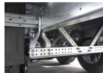
Telaio MODULOS, longherone profilato a cilindro senza saldatura.
