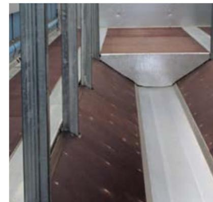
Il supporto combinato per coil semplifica il fissaggio del carico. È adatto alle tasche per montanti nel cassone e anche alle tasche per montanti sul telaio esterno.
