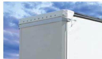
I componenti profilati a cilindro forniscono maggiore stabilità anche alla carrozzeria. Il profilato angolare della sponda frontale e il telaio per il portellone posteriore sono profilati in acciaio strutturati in modo nuovo, in grado di sostenere carichi grazie alla profilatura a cilindro.
