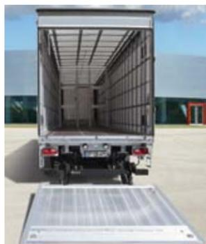
Robusta sponda di carico in alluminio in realizzazione fissa con portellone basculante. Sicurezze antirollio per 2 container su rulli e l'alimentazione laterale autonoma a batteria garantiscono operazioni sicure sul luogo di carico e su quello di scarico.
