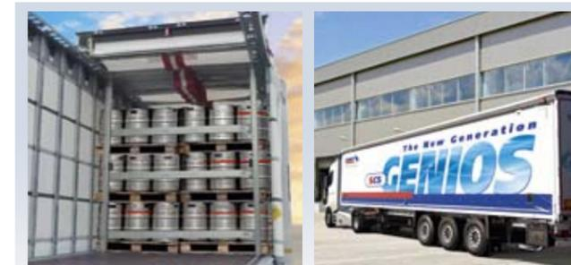
Nel S.CS con SPEED CURTAIN non solo il processo di carico è più veloce, ma anche il fissaggio del carico è semplificato grazie al sistema flessibile di fissaggio del carico.
