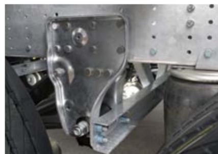
Le caratteristiche di marcia e l'usura degli pneumatici del trailer sono influenzate positivamente dalla esatta geometria della sospensione dell'autotelaio. I collegamenti a perno garantiscono il montaggio preciso e veloce.
