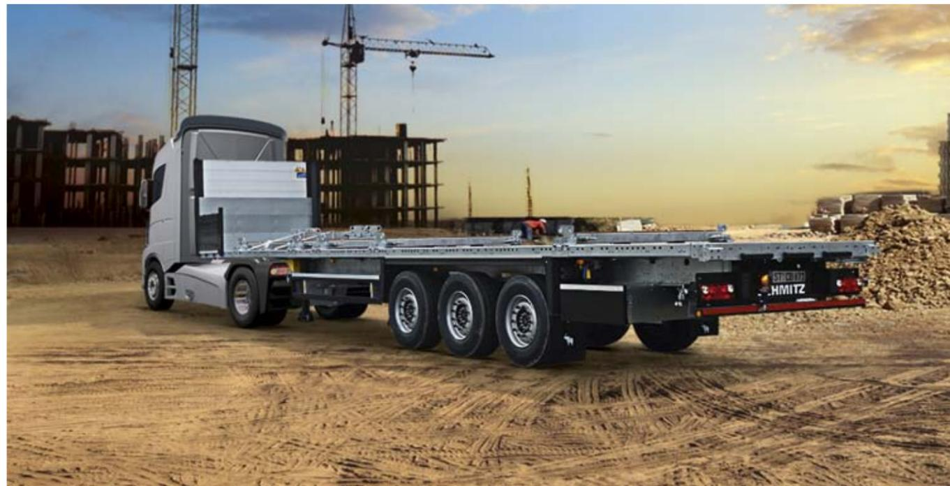
Semirimorchio a pianale S.PL per il trasporto di acciaio con equipaggiamento speciale per carico di larghezza eccezionale: tasche per montanti estraibili, grande cassa di stivaggio dietro l'autotelaio per montanti e altri mezzi di ancoraggio. Quattro pannelli segnalatori estraibili e una luce lampeggiante gialla sul lato posteriore segnalano l'eventuale larghezza eccezionale.
