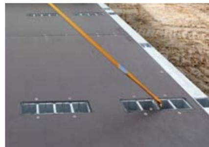
Ciascun magazzino per tasche per montanti da 4 pezzi contiene occhielli per l'ancoraggio verso il basso con cinghie di serraggio. Inoltre nel telaio esterno 13 coppie di occhielli di ancoraggio per carichi pesanti facilitano il fissaggio del carico fino a 5 t.
