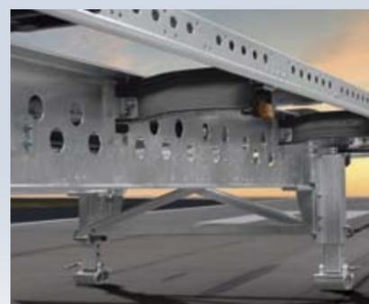
La struttura leggera dello chassis X-Light, una combinazione di acciaio ad alta resistenza e alluminio, offre una elevata resistenza con peso ridotto.
