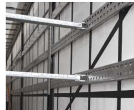
Fissaggio perfetto del carico grazie a barre trasversali nel reticolo forato a maglia stretta dei sopralzi in acciaio.
