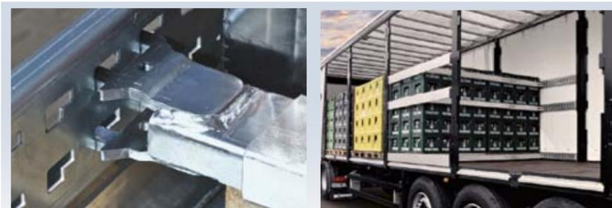
Nel sistema flessibile di fissaggio del carico, le barre trasversali possono essere posizionate esattamente con una guida perforata nei sopralzi in acciaio. Esse vengono utilizzate con due semplici maniglie.
